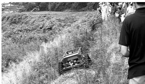
[ラジコン草刈機を活用した法面除草]
