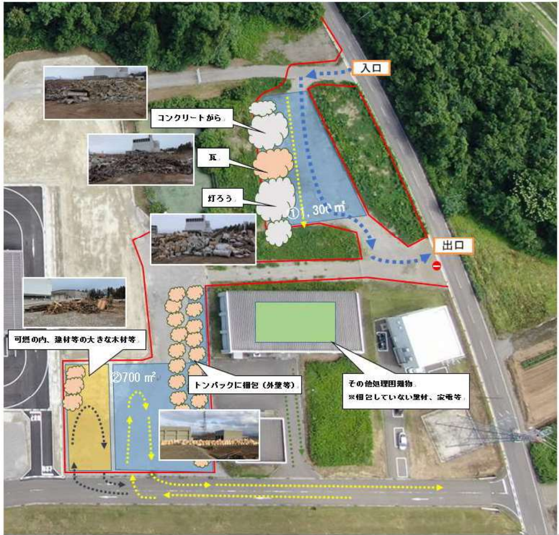
図 5-1 1-4 令和6年能登半島地震時の仮置場の設置図面
