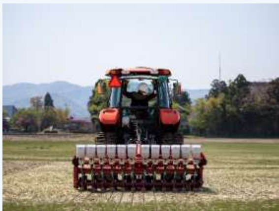
▲直進キープ機能付機能付トラクタによる V 溝 乾田直播
